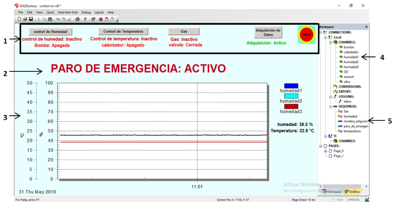
Figura 11 HMI del control ON-OFF
