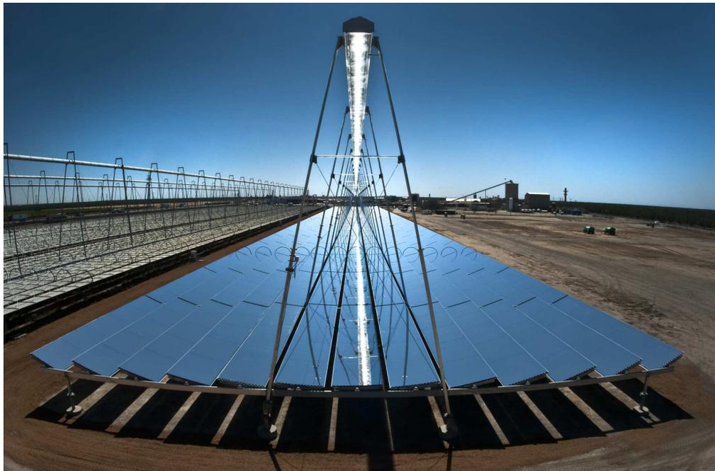
Fig. 3.2: Concentrador lineal fresnel.
