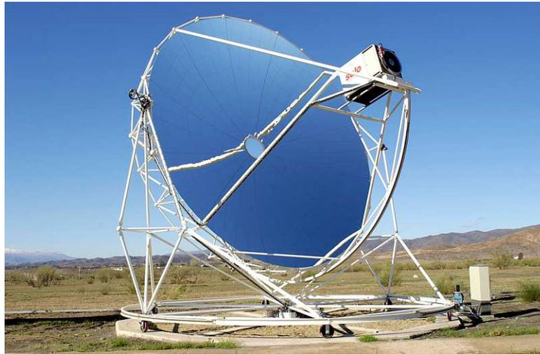
Fig. 3.3: Concentrador de disco parabólico.
