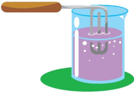
1. Calienta 400 ml (400 g) de agua con el calefactor durante tres minutos. Anota las temperaturas inicial y final y calcula el cambio de temperatura.
